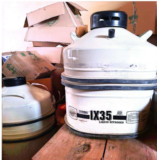
फोटो ३: Cryoseal IX35 तरल नाइट्रोजन कन्टेनर (३५ लिटर क्षमता) — मैदान भ्रमणमा प्रयोग
