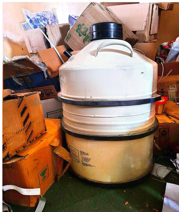
फोटो २: ठूलो क्षमताको तरल नाइट्रोजन मदर कन्टेनर (INOXCVA) — दीर्घकालीन वीर्य भण्डारणका लागि
